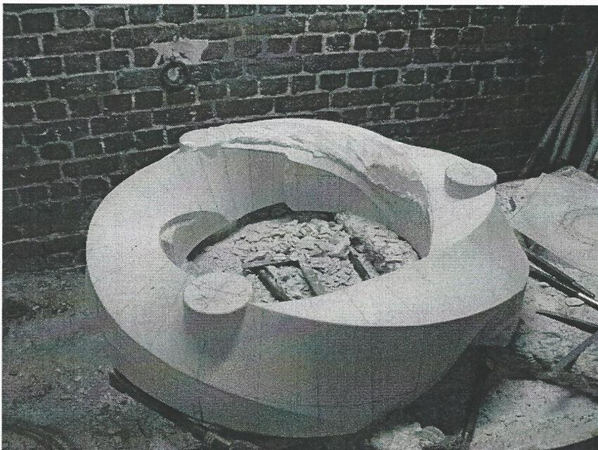
Une fois taillé au maximum le carré torse sur le lit d'attente, retourner l'anneau et continuer la méthode de taille. Au moyen de l'équerre on vérifie les arêtes du carré sur les génératrices.
